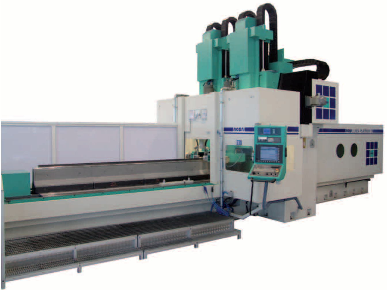
Rettificatrice mod. PLATINUM TH costruita da Rosa Ermando SpA per la finitura delle piste di scorrimento della monoguida MG
